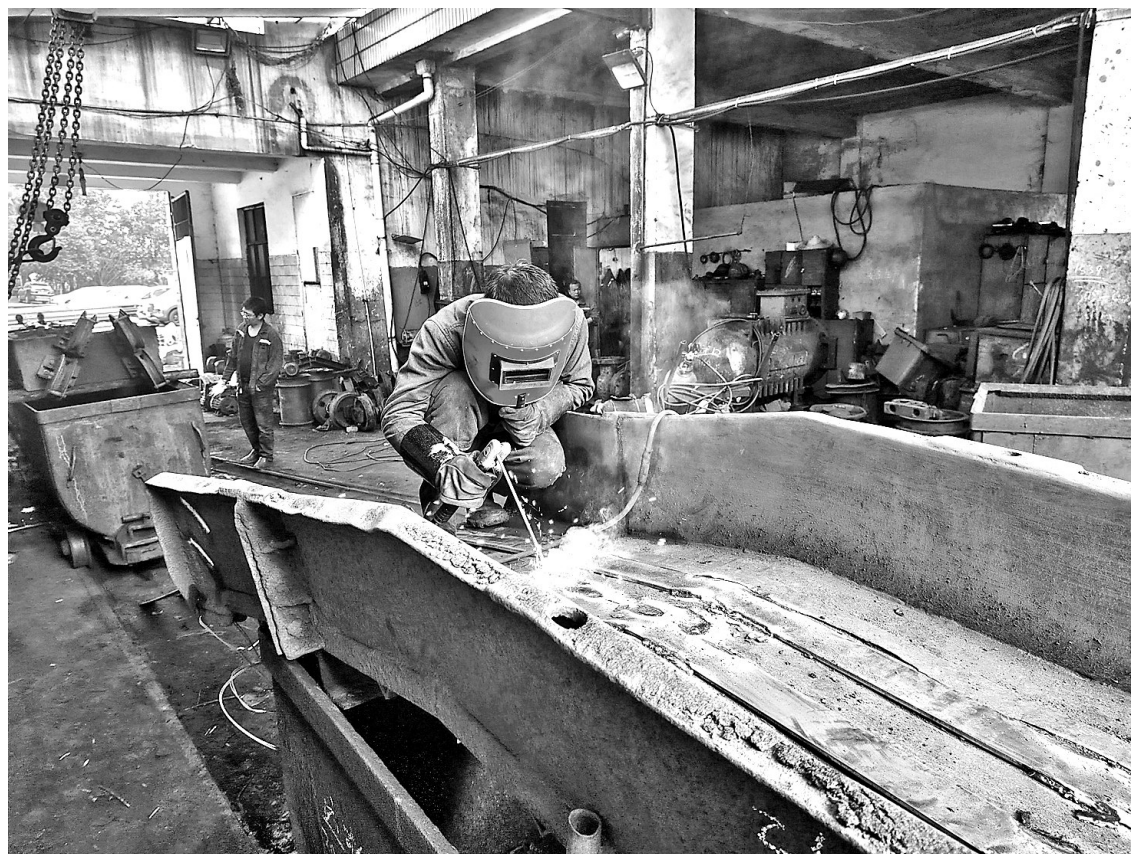
1月5日,福建煤电公司翠屏山煤矿井下一台耙岩机突发故障被调出至维修车间。为尽快恢复生产,机修人员放弃周末休息,紧急抢修故障耙岩机,经过2个多小时的维修加固,最终完成抢修任务,保障安全生产正常进行。(邱素梅 张文环 摄)
