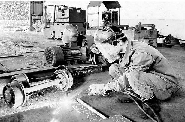
在维修矿车。旧矿车回收复用,降低损耗等措施,职工成本意识、节约意识入手,通过修旧利废、回收复用、降低损耗等措施,推动降本增效。图为近日,机修工人永安煤业公司水井坑煤矿从增强(潘金鹏 摄)
