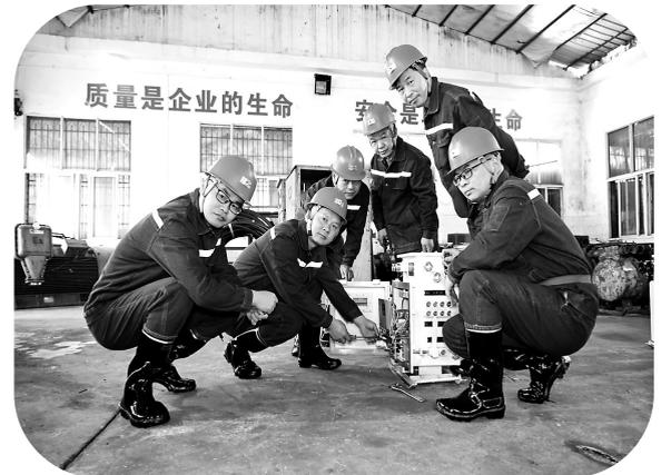
图为翠屏山煤矿机电队技术骨干在调试真空磁力启动器的场景
